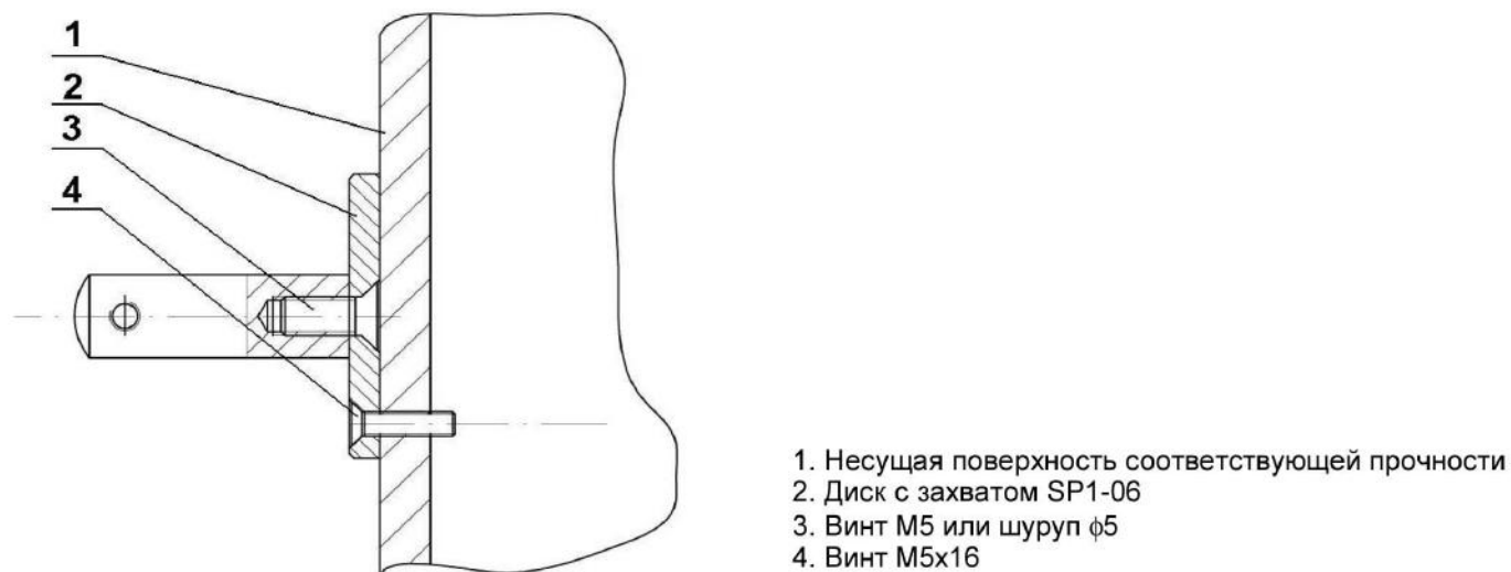
Рис. 19. Монтаж диска непосредственно к несущей поверхности
